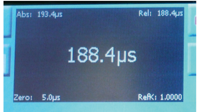
Fotografia 3. Exemple de la determinació del temps de propagació d'ona
